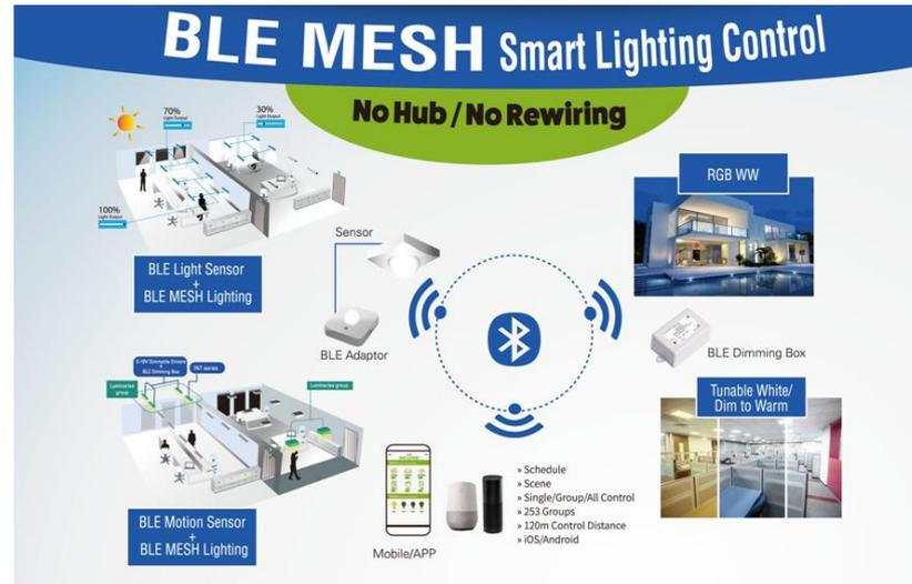
INCORE 品牌之基礎產品係以藍牙網狀網路無線控制 Bluetooth Low Energy Mesh (BLE Mesh) 為主要技術之模組，其主要產品包括燈控軟體 APP、燈控韌體、藍牙調光盒 AC BLE Dimmer (AC-DC)、藍牙控制盒 BLE Controller (DC-DC)、藍牙遙控器 (BLE Remote Controller)、藍牙牆面開關器 (BLE Wall Switch)。
